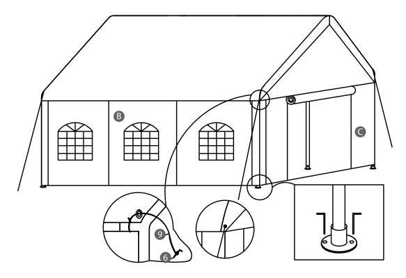
Die Abspannseile 9 werden durch die Ringösen in den 4 Ecken des Daches gefädelt und direkt am Metallrohr verknotet.
